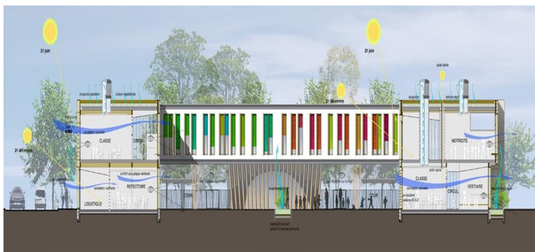
Figure 33 : ventilation naturelle de groupe scolaire Simone Viel .Source : TEKHNE ARCHITECTURE.
