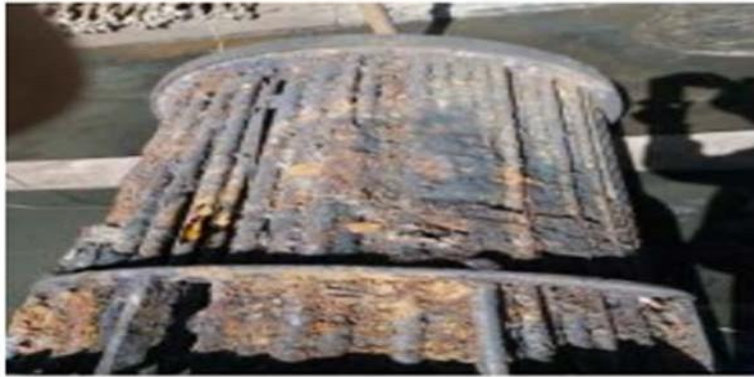
Figure II.4 : Bouchage faisceau tubulaire d'un échangeur [4]
