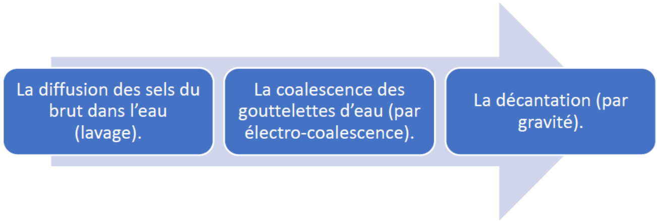
Figure III.2.4 : Étapes de dessalage du brut [11]
