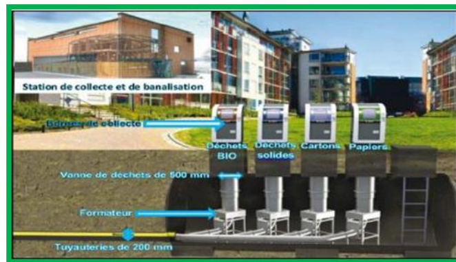
Fig 103: photo représente relation entre les bornes de collecte et la station de traitement de déchets
