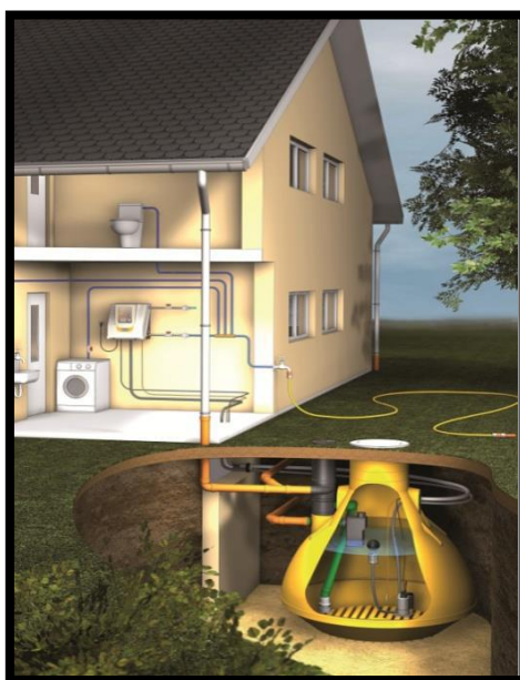
Photo 71 : Récupération des eaux pluviales
