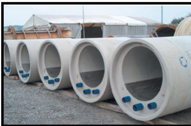
Photo 72 : La récupération de la chaleur des eaux usées
