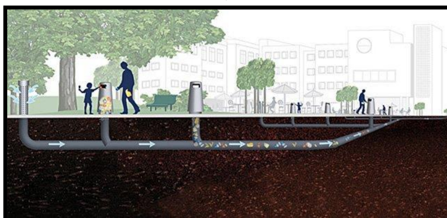
Photo 06: installation souterraine aspiration des déchets SOURCE : www.vertfocus.com
