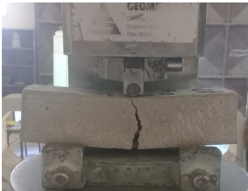
Figure III. 2 : Epreuve fléchée jusqu'à la rupture.
