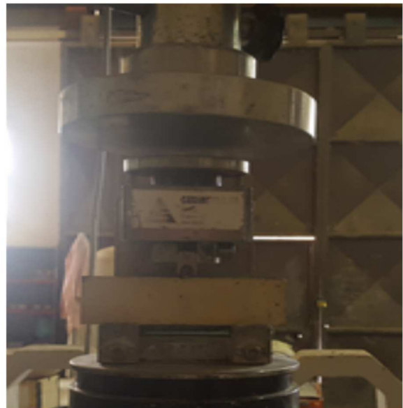
Figure II. 10 : Dispositif pour l'essai de résistance à la traction par flexion.
