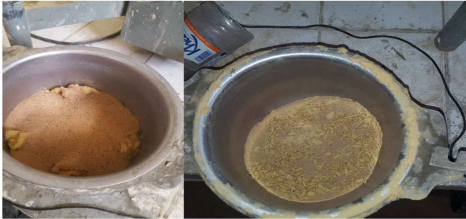
Figure II. 7 : Le malaxage automatique de laine de verre avec le sable.
