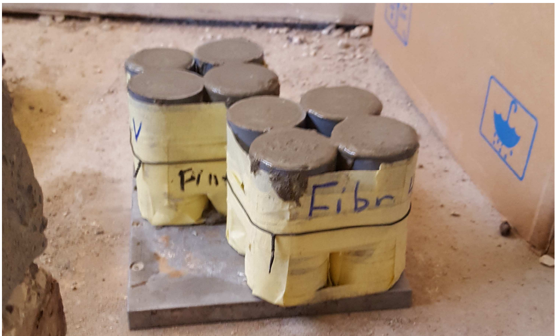
Figure II. 13: les éprouvettes utilisées pour l'essai d'arrachement.
