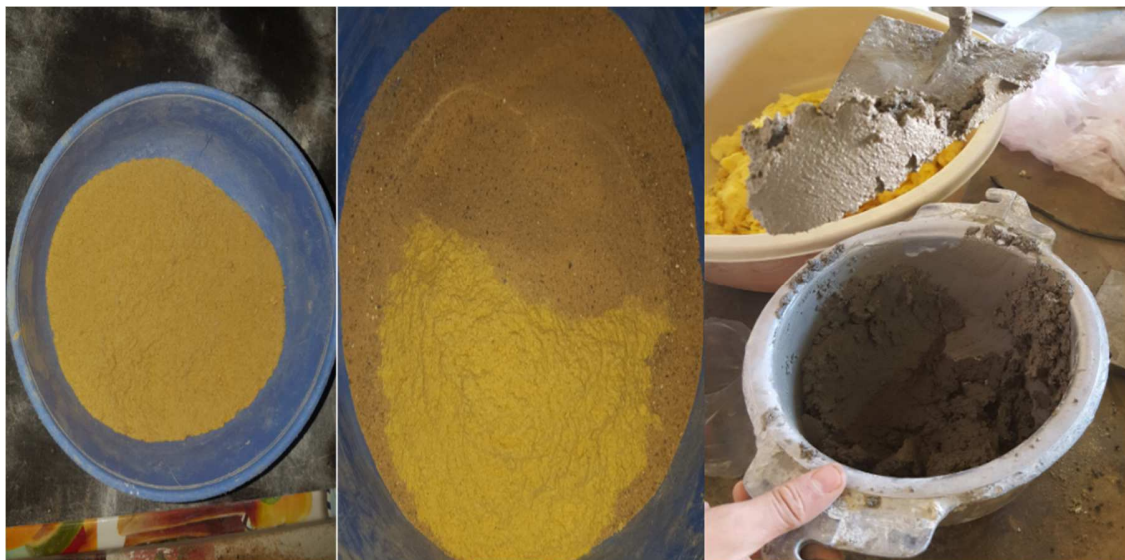
Figure II. 8 : Les différents étapes pour élaborer le mortier de fibre de verre.
