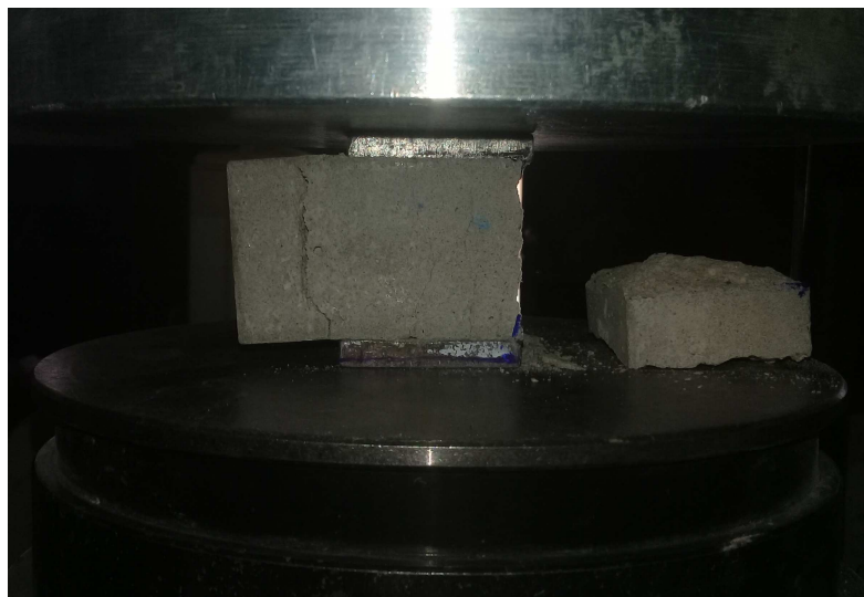
Figure III. 4 : Eprouvette écrasé par compression
