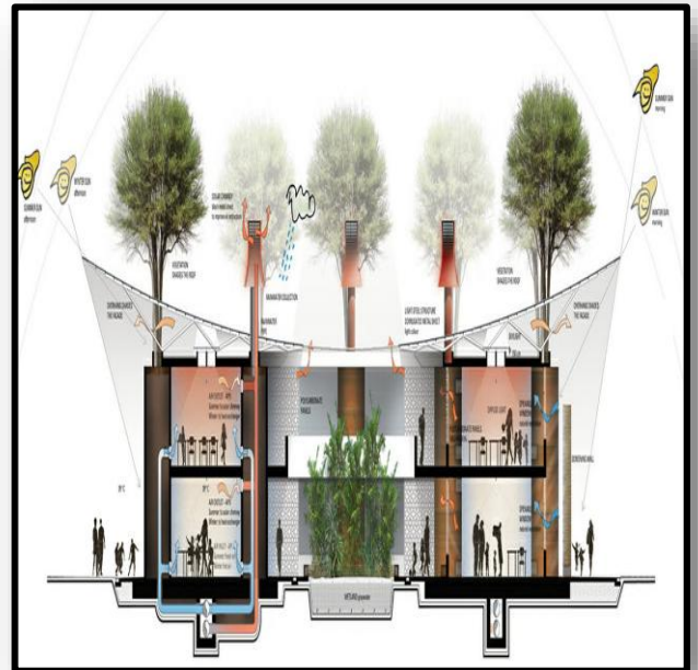
Figure 34 : Coupe schématique présente le système de chauffage et refroidissement.
