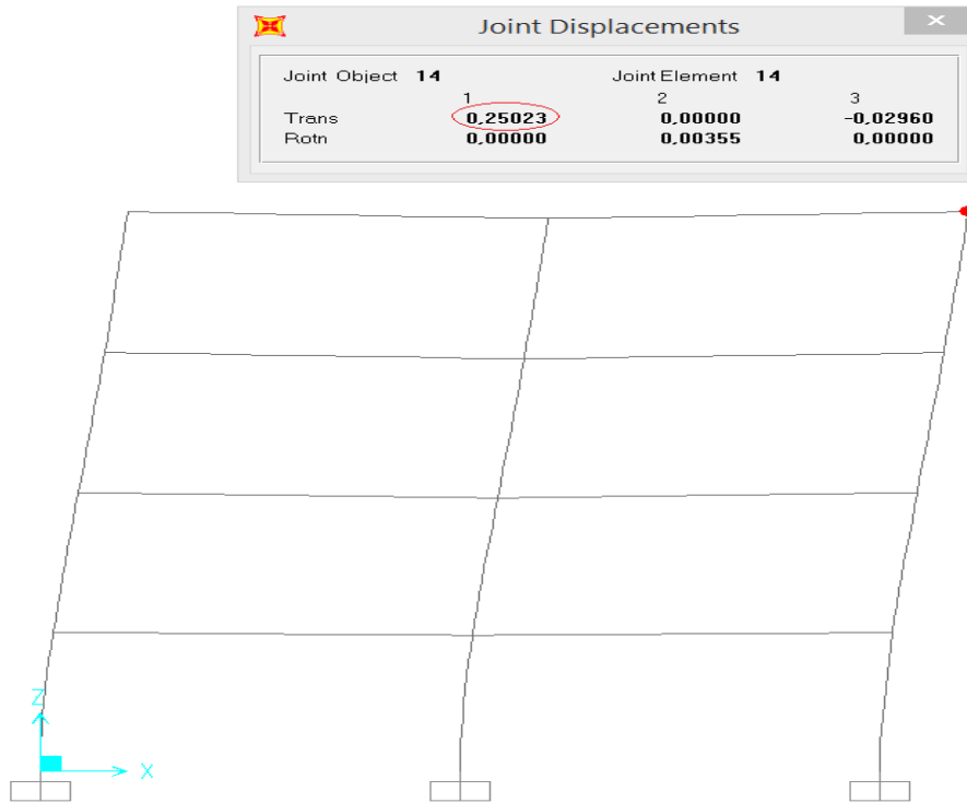
Figure V. 4.a: La déformation d'un portique de quatre étages et deux travées avec rigidité initiale égale à 2000,00 kips.ft/rd
