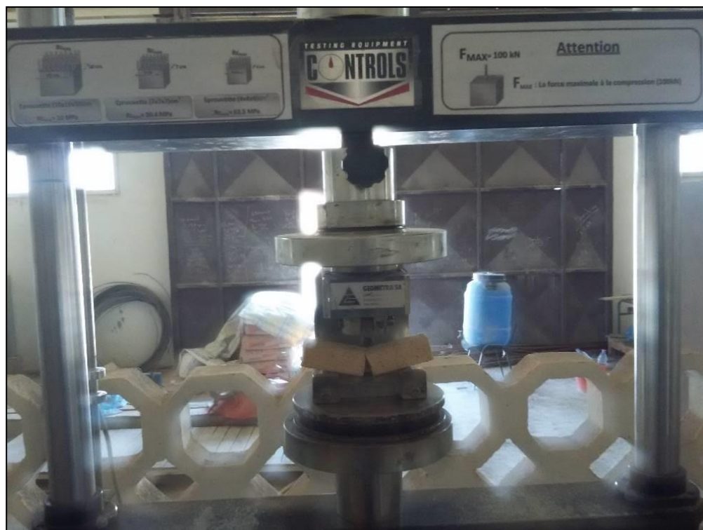
Fig. II.18 Dispositif pour l'essai de résistance à la compression.
