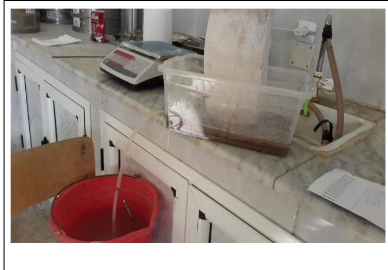
Photo III.7 : Essai d'absorption capillaire (Laroui I, 2017)
