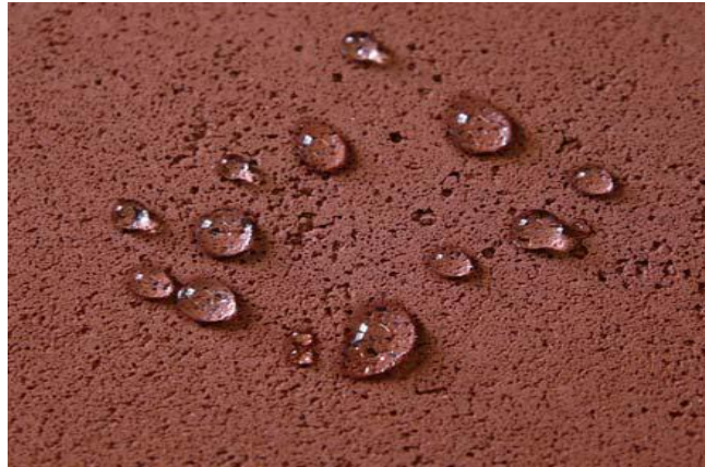
Photo III.1 : Gouttes d'eau sur un enduit de terre rouge de Royan avec du blanc d'œuf (Aurélié Vissac/CRAterre-ENSAG)
