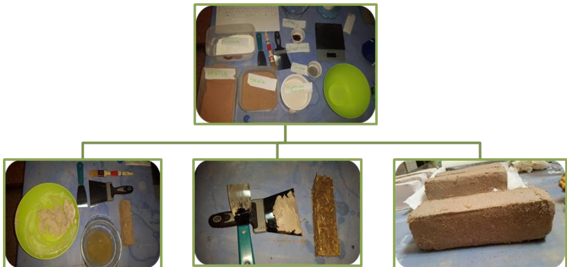
Photo III.4 : Etapes d'application de l'enduit de revêtement (Laroui I, 2017).
