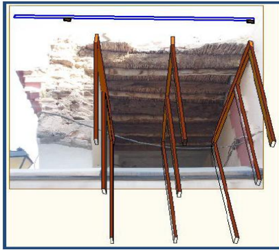
Figure II.49 : consolidation du plancher avec étaiments en bois au niveau de l'espace d'ablution Source : PPMVSA
