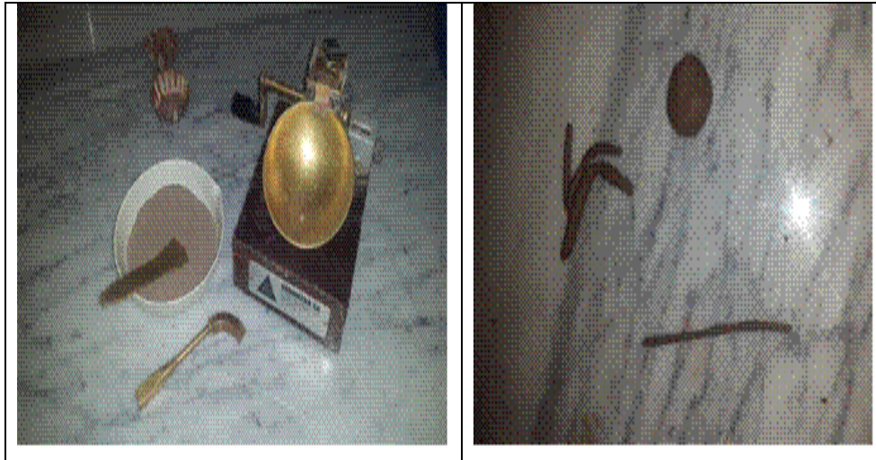
Photo III.2 : Essai de limite de plasticité (Laroui I, 2017)
