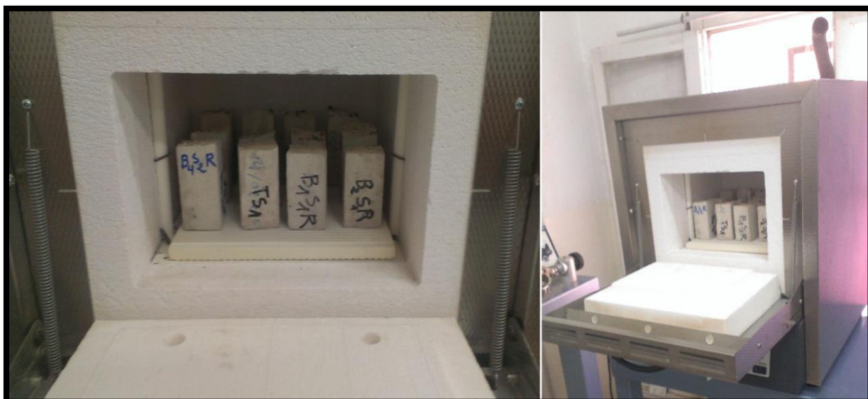
Photo II. 10: Echauffement des éprouvettes dans un four à moufle (Sahraoui. M and Nebih. I, 2015)
