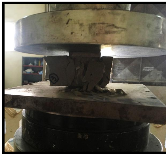
Photo II. 7: Presse utilisé pour l'essai de compression.
