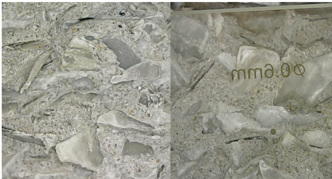
Photo III. 8: Images de microscope optique de (0.6mm) montrent l'adhérence matrice-PET.
