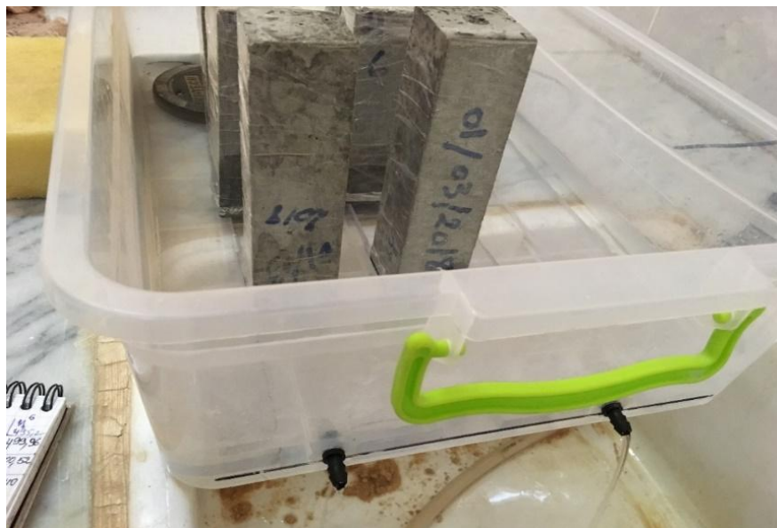
Photo III. 7: Montage expérimental utilisé dans l'essai d'absorption.
