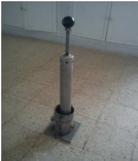
Photo II. 8 Moule Proctor Normal avec la dame dans laboratoire de Génie Civil (Laghout).
