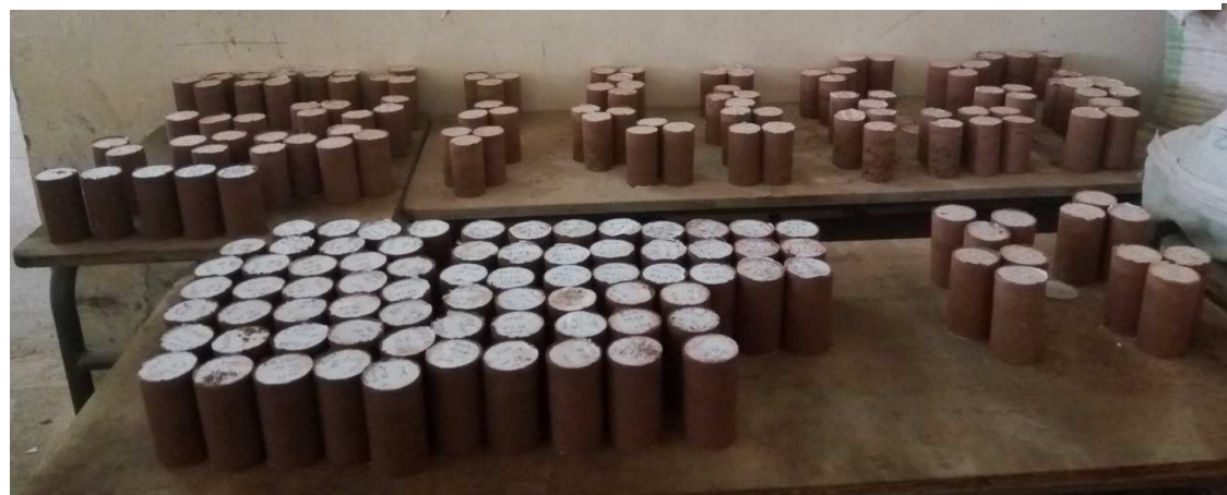
Photo IV.3 Les échantillons non traités (argile + sable de dune) qui ont été testés lors de l'étude
