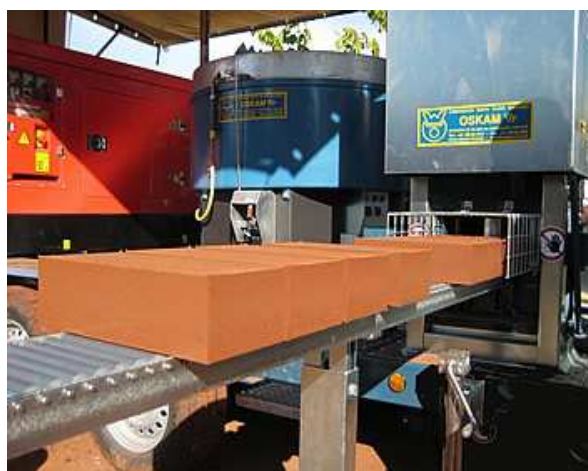
Photo I. 17 Fabrication des blocs de terre comprimée à l'aide d'une presse mécanique ( www.oskam-vf.com )
