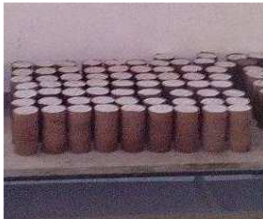
Photo IV.1 Les échantillons non traités (argile pure) qui ont été testés lors de l'étude
