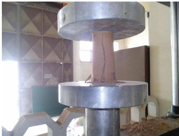
Photo IV.5 Essai de compression simple en laboratoire de Génie Civil (Laghout)
