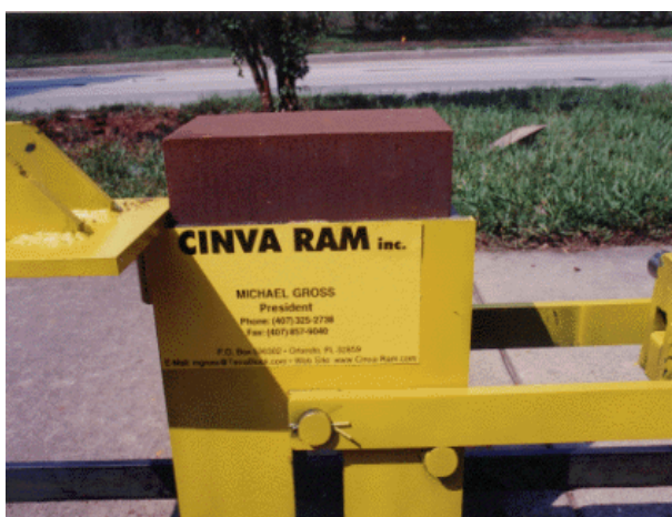
Photo I. 16 Fabrication des blocs de terre comprimée à l'aide d'une presse manuelle (Cinva Ram) ( www.papercrete.com )
