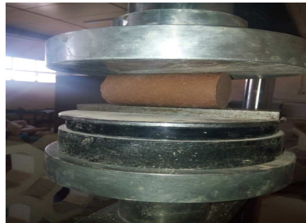
Photo IV.6 Essai de traction par fendage (Essai Brésilien) au laboratoire de Génie Civil (Laghout)
