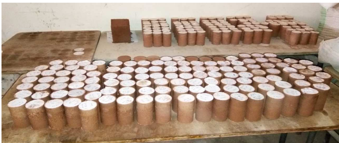
Photo IV.3 Les échantillons non traités (argile + sable de dune) qui ont été testés lors de l'étude
