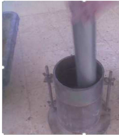
Photo II. 8 Moule Proctor Normal avec la dame dans laboratoire de Génie Civil (Laghout).
