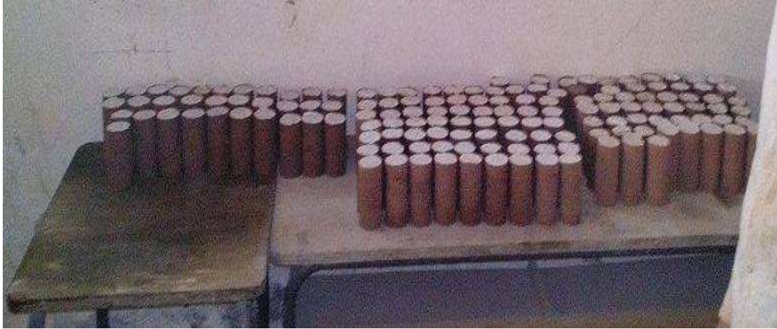
Photo IV.2 Les échantillons non traités (argile + sable de dune) qui ont été testés lors de l'étude
