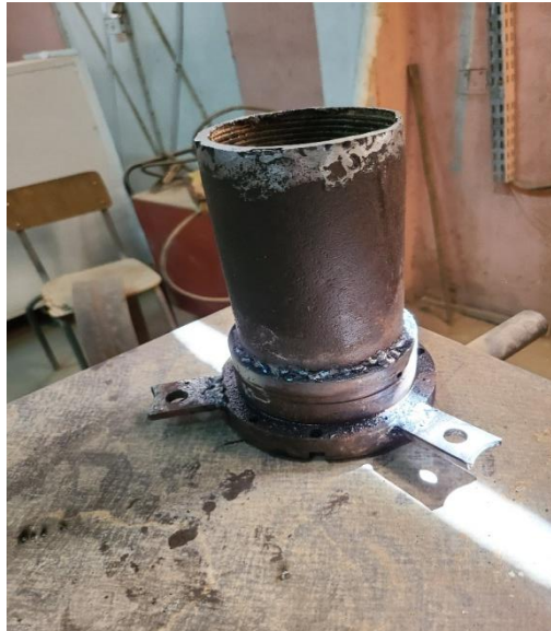
Figure III. 6. Soudage des trois éléments en fer plat avec la pièce 2 et 3.
