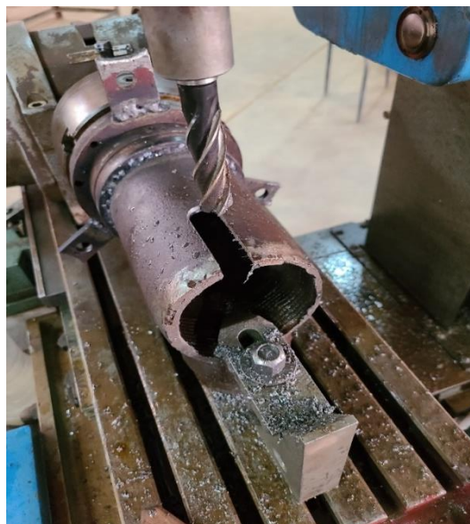
Figure III. 7. Exécution de la rainure sur la pièce 2 en utilisant une fraiseuse verticale.
