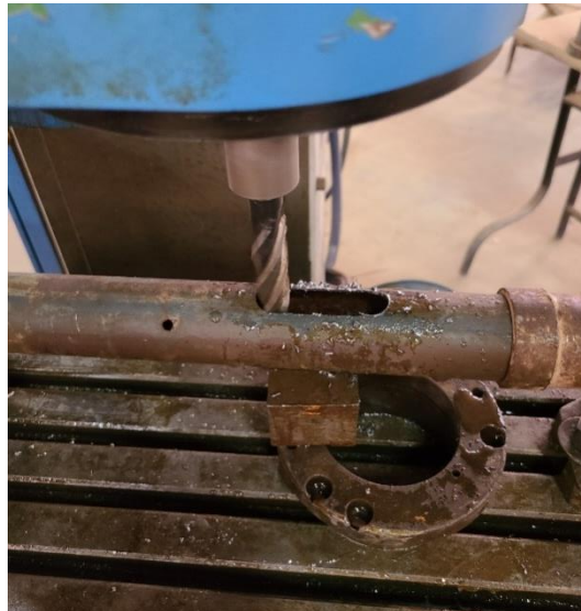
Figure III. 9. L'exécution d'une rainure sur la pièce porte manchon en bois.
