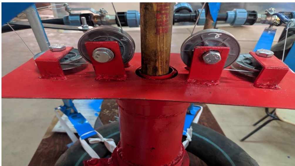
Figure III. 12. plaque par guidage de câble
