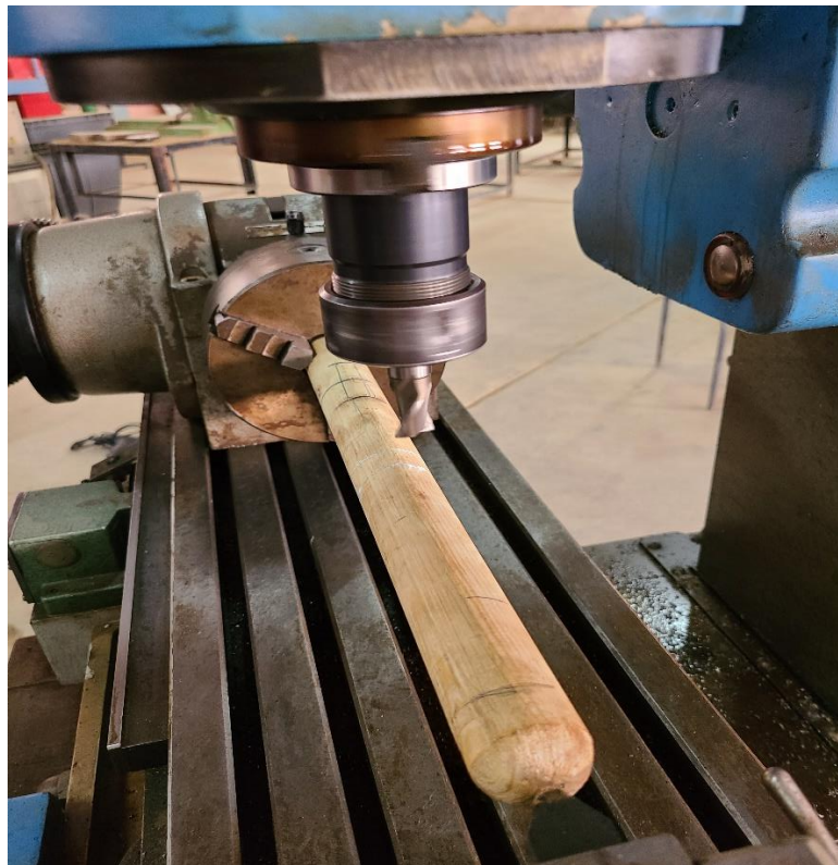
Figure III. 10. L'exécution d'une rainure sur la pièce manchon en bois.
