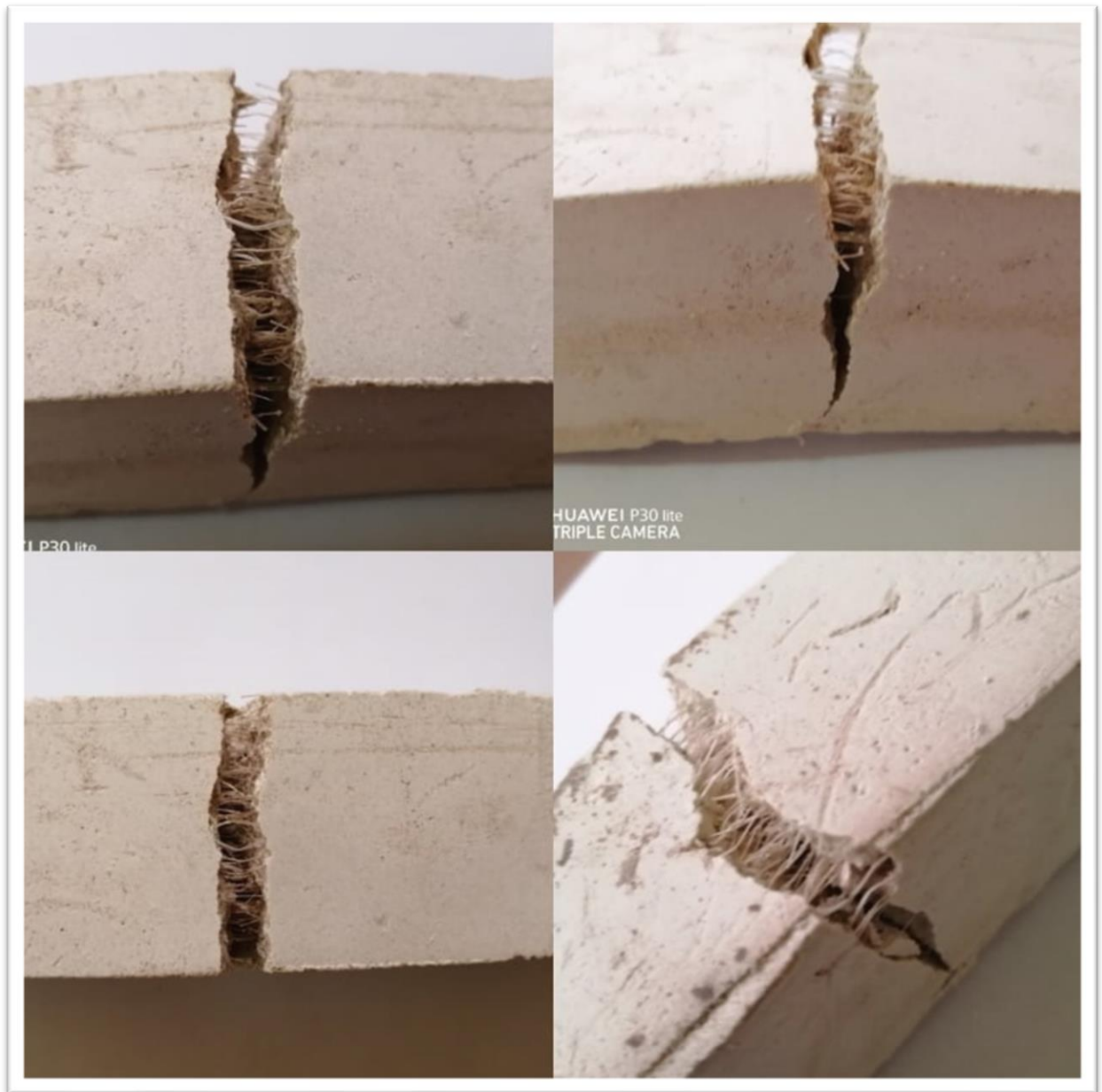
Figure 3: les éprouvettes après l'essai de flexion.
