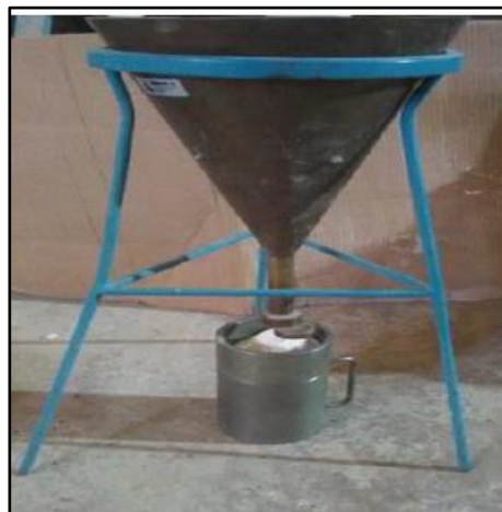
Figure II.5: Dispositif pour l'essai de la masse volumique apparente.
