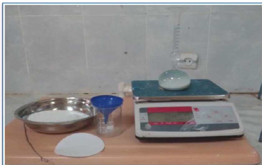
Figure II.3 : Equipement nécessaire pour l'essai de la masse volumique absolue.
