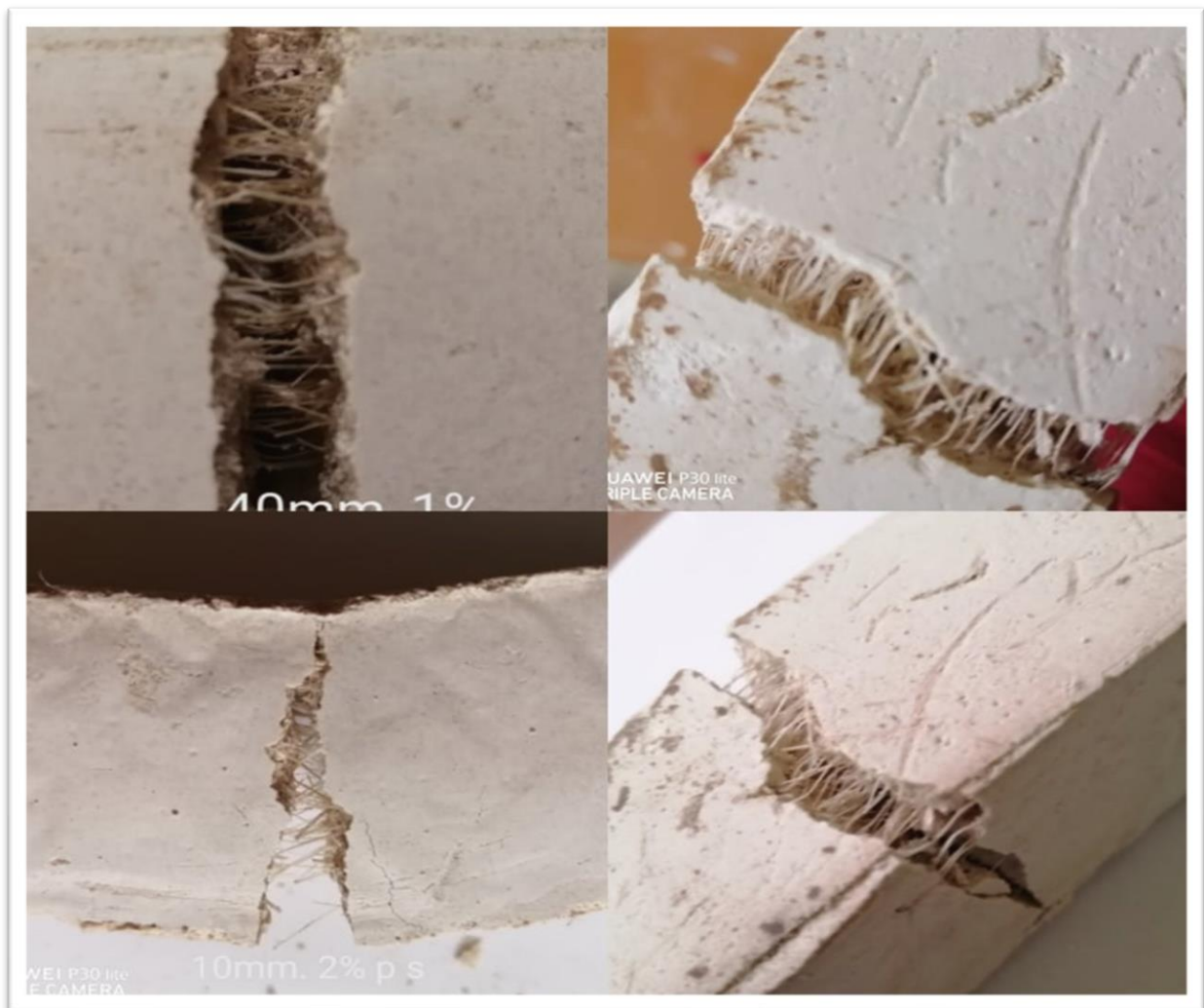
Figure 5: les éprouvette après l'essai de flexion.
