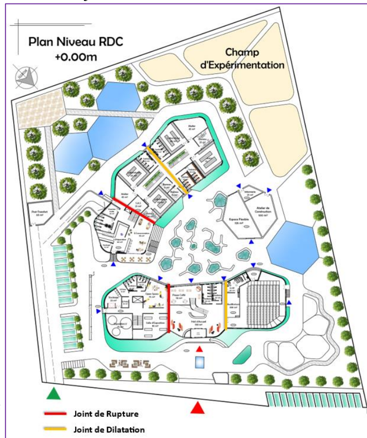
Figure 197 : L'application des joints au niveau du projet Source : Auteur
