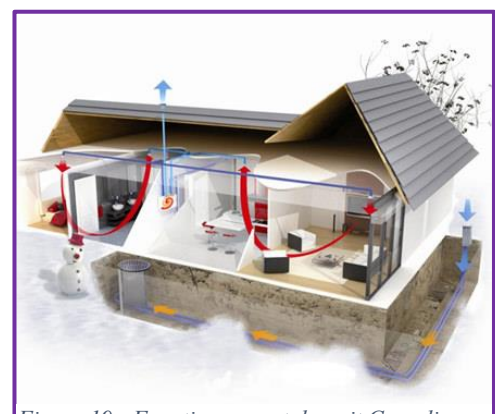
Figure 19 : Fonctionnement du puit Canadien en hiver
