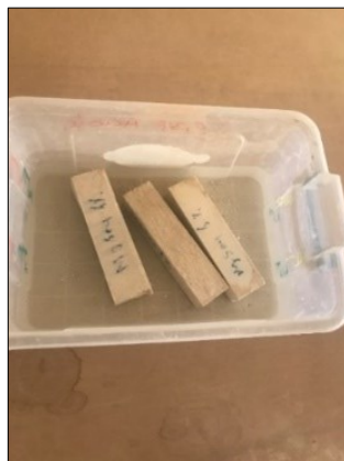
Figure II-15: Conservation des éprouvettes dans les milieux agressifs.
