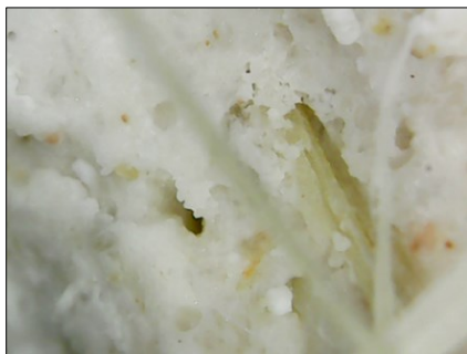
Figure III-9 : l'échantillon de mortier de plâtre avec fibres conservé dans l'eau.
