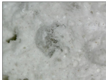
Figure III-10 : l'attaque de MgSO_4 à la matrice de plâtre.
