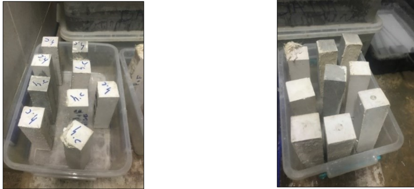
Figure II-16 : Conservation des éprouvettes dans les milieux hygrométriques.
