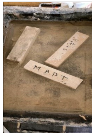
Figure II-15: Conservation des éprouvettes dans les milieux agressifs.
