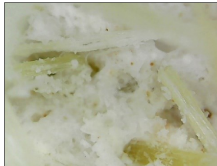
Figure III-8 : matrice mortier de plâtre avec fibres conservée continuellement dans l'humidité.
