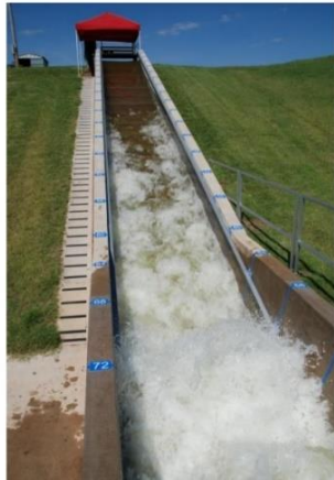
Photo 1.2 : Des expériences ont été menées sur ce modèle réduit d'une pente 14^\circ dans l'unité de recherche en génie hydraulique USDA-ARS de l'Université Stillwater, Oklahoma, États-Unis ( Hunt & Kadavy, 2016 )
