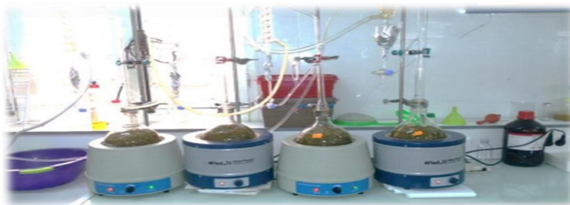
Figure 8. Montage d'hydro-distillation employé pour l'extraction des huiles essentielles (Djaber et al. , 2019)
