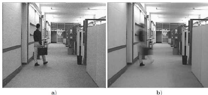
Figure 20 Application du filtre de moyenne temporelle, (a) vidéo originale (b) vidéo filtrée
