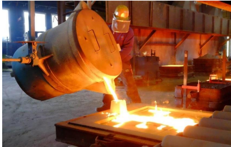
Figure 2 Coulée de métal en fonderie pour la fabrication de pièces
