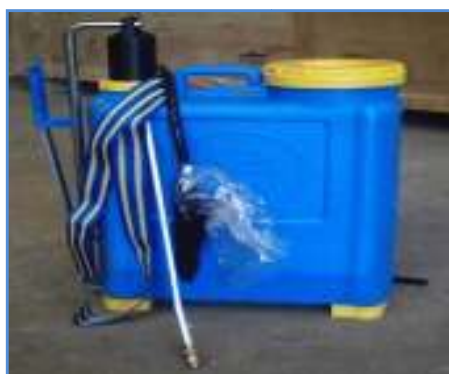
Figure. 13 : Photo représente le pulvérisateur à dos manuel (originale 2014)
