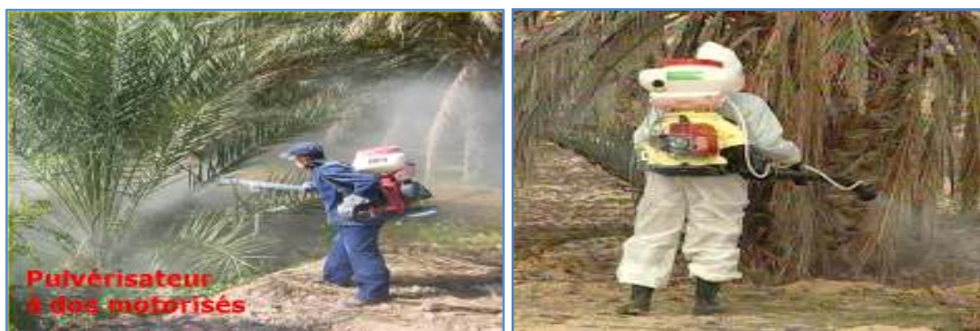
Figure .14: Photos représentent le pulvérisateur à dos motorisés (originale 2014)
