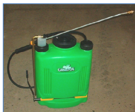
Figure. 13 : Photo représente le pulvérisateur à dos manuel (originale 2014)
