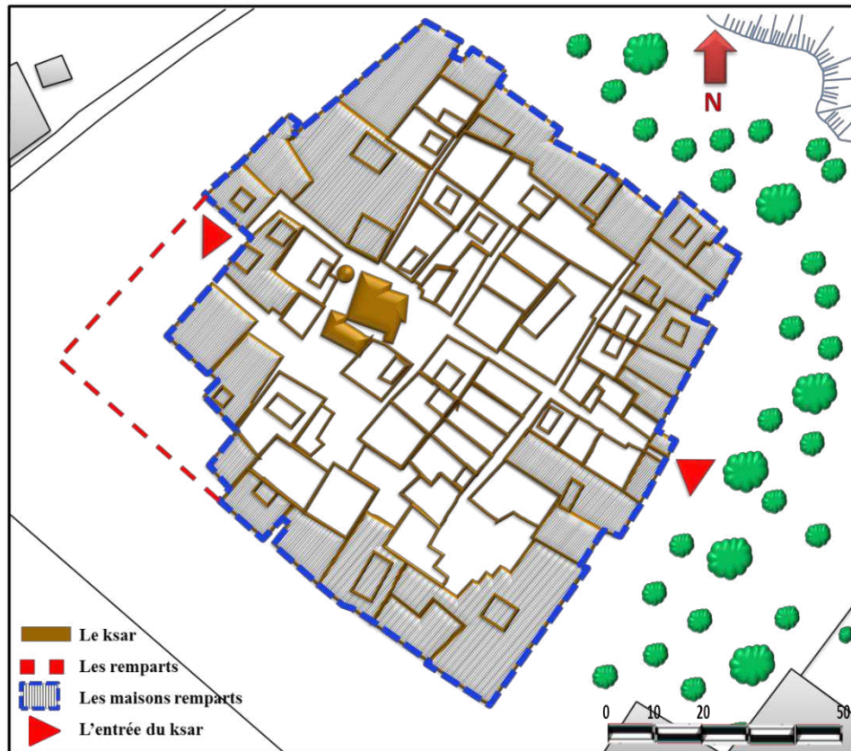
Fig 66 : Plan de la restitution et de la réhabilitation des maisons remparts du ksar d'El-Haouita Source : (auteure)
