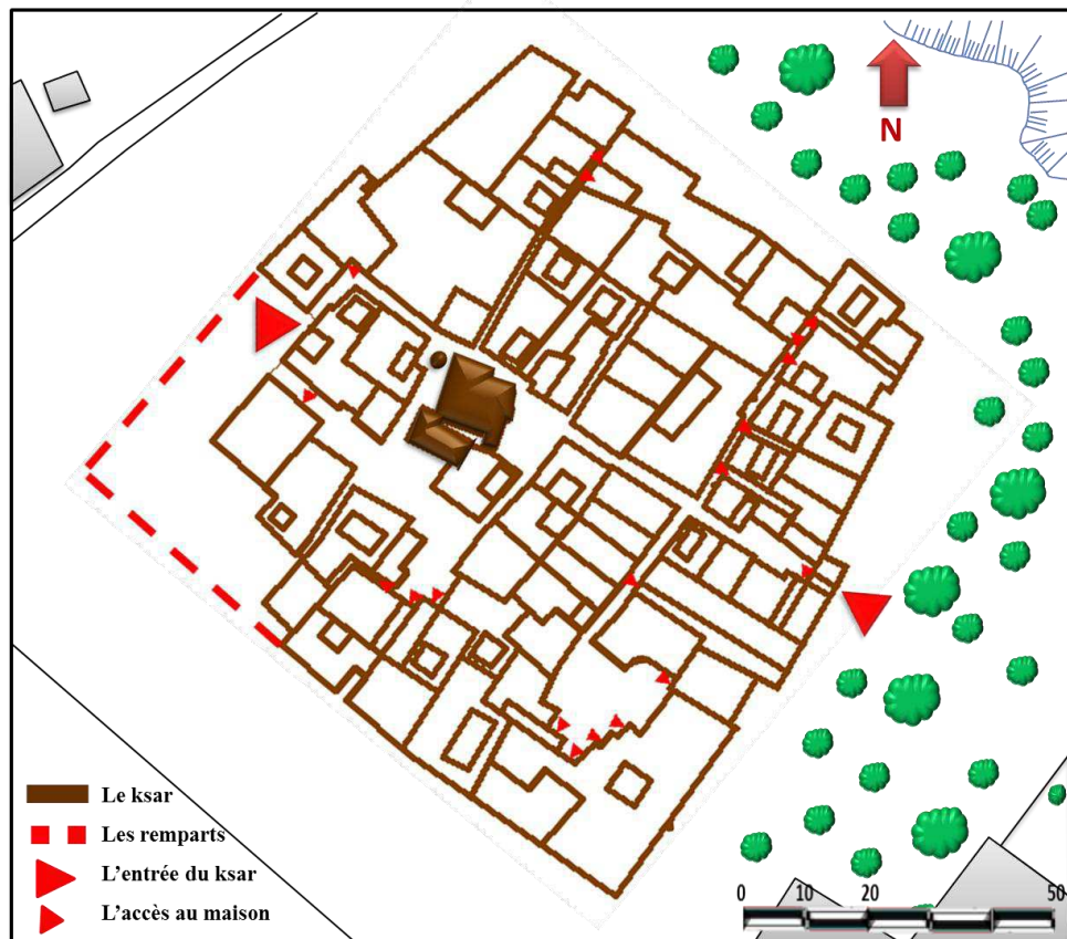
Fig 69 : Plan de réaménagement des accès des maisons remparts du ksar d'El-Haouita vers l'intérieur Source : (auteure)
