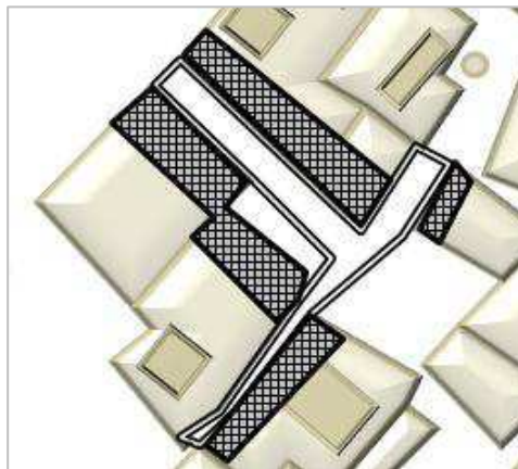
Fig86 : Cas où on a interposé entre la rue et le bâtiment un espace libre résiduel qui servira d'articulation géométrique. La géométrie de l'espace bâti ne dépend plus que du système parcellaire.
