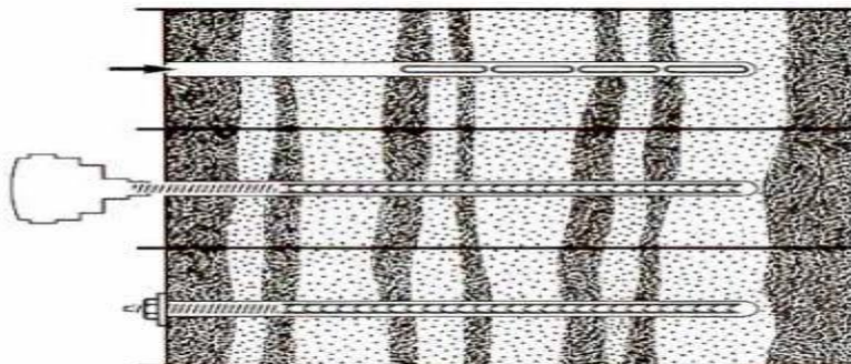
Figure IV.13. Boulonnage à ancrage réparti à la résine
