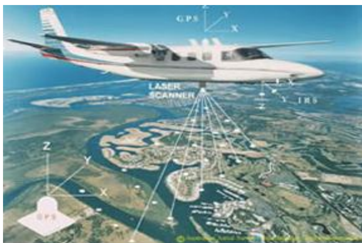
Figure II.3 Utilisation du GPS en Photogrammétrie Aérienne
