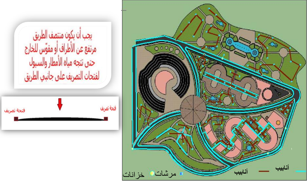
الصورة رقم (142) توضح جمع مياه الأمطار وتوزيعها المصدر : من إعداد الطالب
