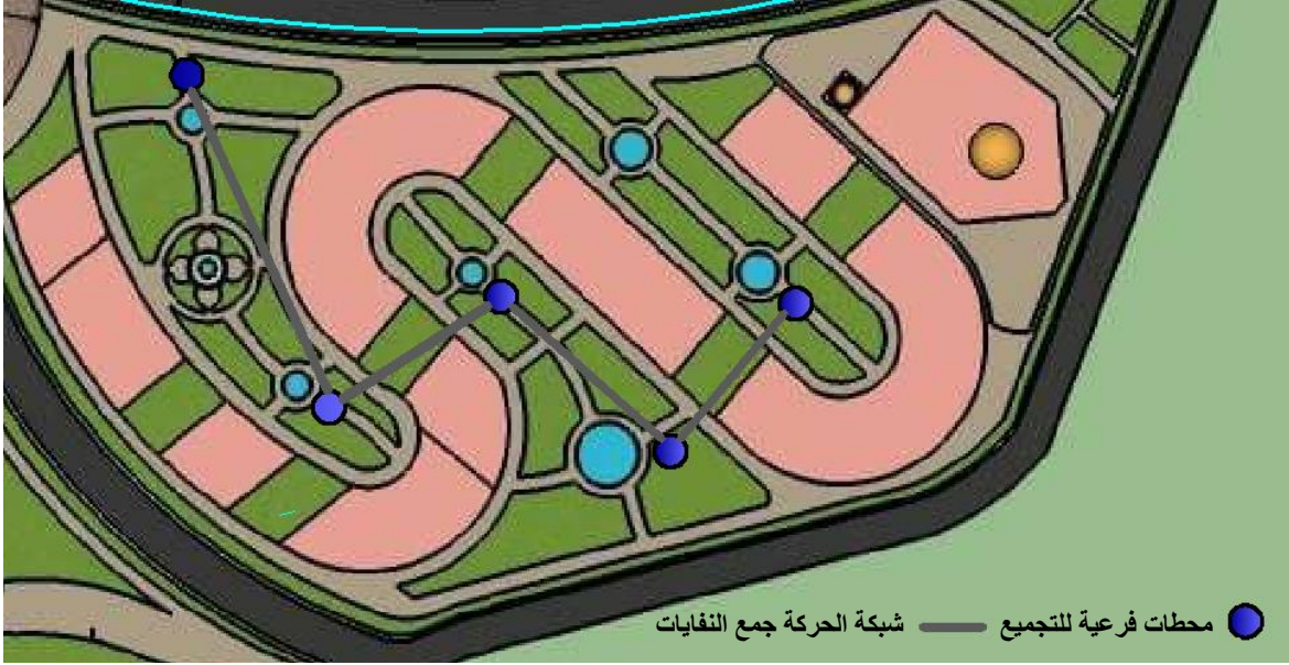
الصورة رقم (107) – توضح تسيير النفايات
