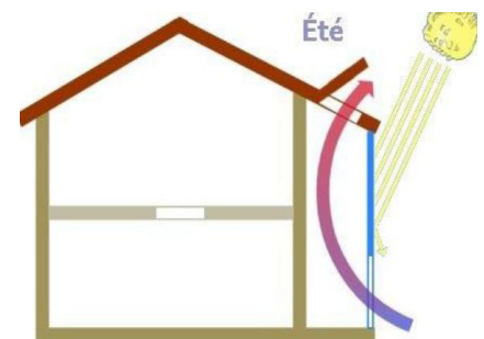
Figure 185 : La ventilation de la serre en été
