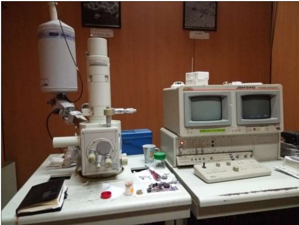
Figure III- 15 : Le microscope à balayage JOEL JSM-5400 (centre CMRDI EGYPT)
