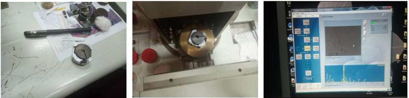
Figure III- 16 : Préparation des échantillons pour la microanalyse EDS sur MEB
