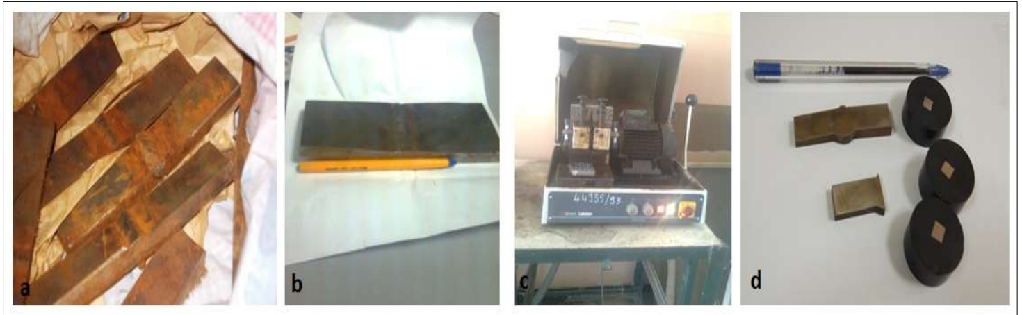
Figure III- 5: a et b) Decoupage grossier des échantillons, c) Tronçonneuse pour découpage de finition, d) Echantillon pour mesure de dureté, observation métallographique et EDS par MEB
