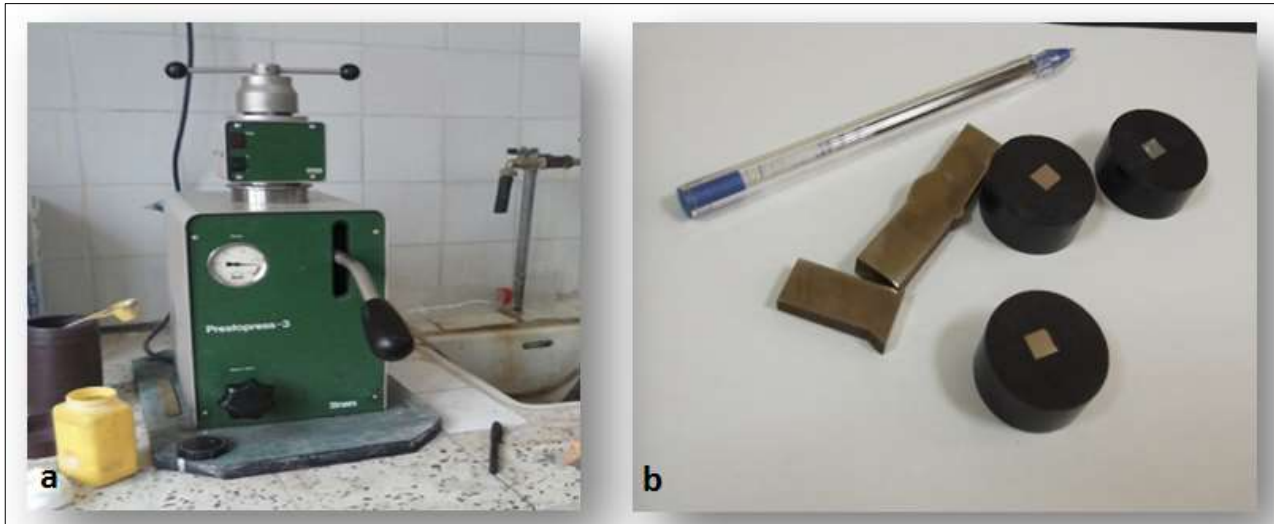
Figure III- 12: a) Enrobeuse a chauds, b) Echantillon enrobé pour observation micrographique
