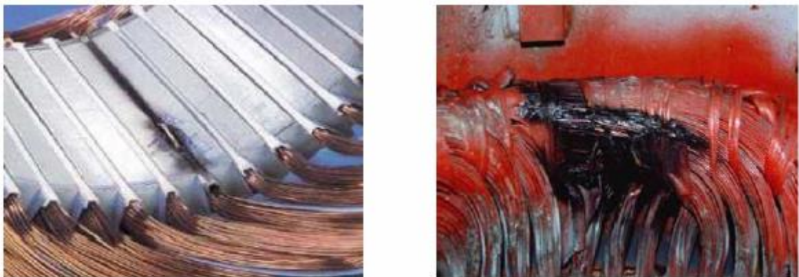
Fig. II.6. Court-circuit entre phases-bâti
