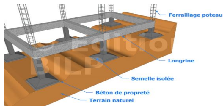
Figure V-1 : semelle isolée Source : www.maconnerie.bilp.fr
