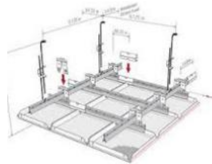
Figure V. 8 : Détails d'un faux plafond démontable
