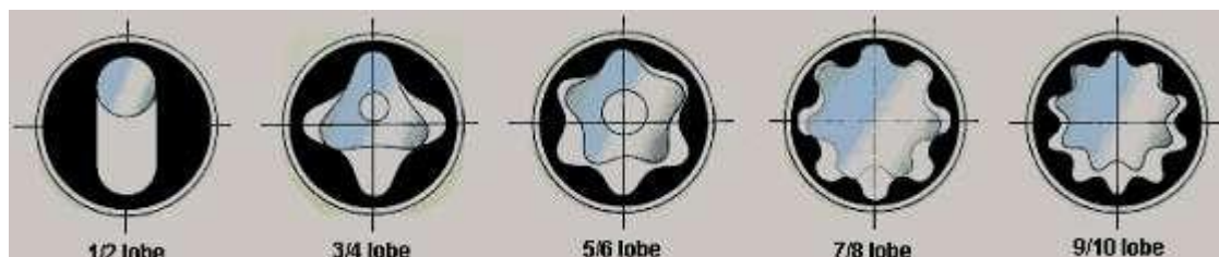
Fig.III.6. Configurations des moteurs de fond
