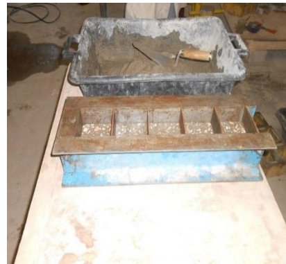
Figure V.7. Coulage des éprouvettes prismatiques en deux couches 5cm béton et 5cm mortier
