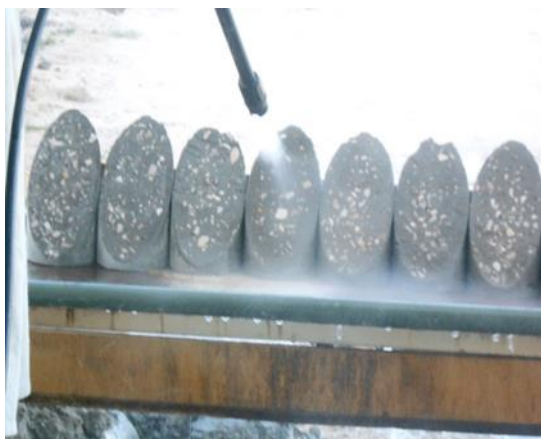
Figure V.5. Préparation de surface Eprouvettes cylindrique 10×20.
