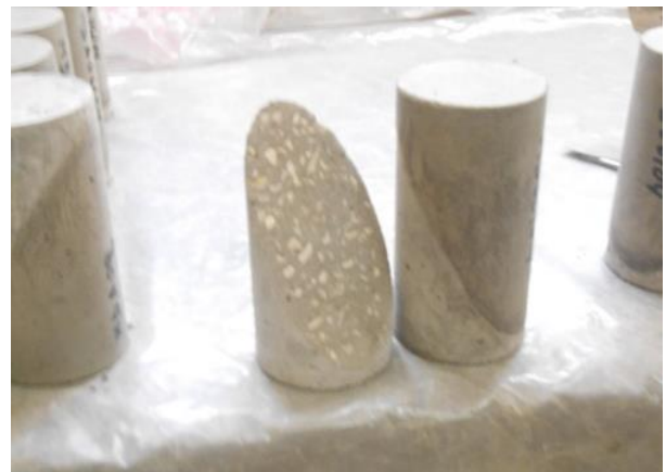
FigureV.8. Eprouvette cylindrique 10×20cm avant et après coulage de mortier
