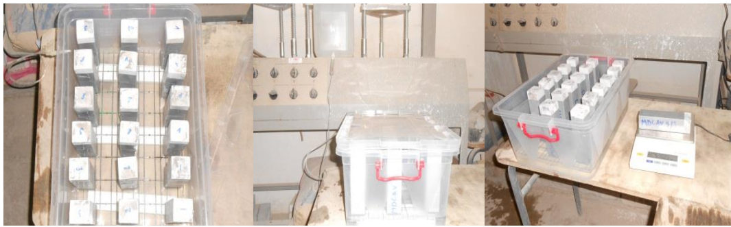
Figure III.14. Dispositif expérimental de l'essai d'absorption capillaire
