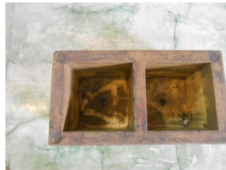
Figure.V.1. Moule d'éprouvettes prismatique 10×10×10 cm
