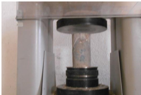
Figure V.13. Essai de cisaillement (slant shear)
