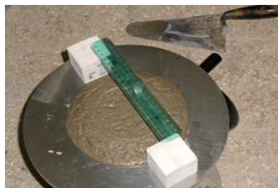
Figure.IV.5. Etalement du mortier par la table à secousses
