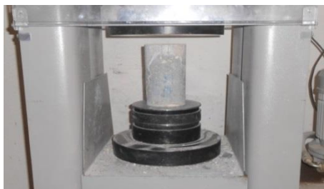
Figure.IV.4.Essai de compression simple sur des éprouvettes cylindrique
