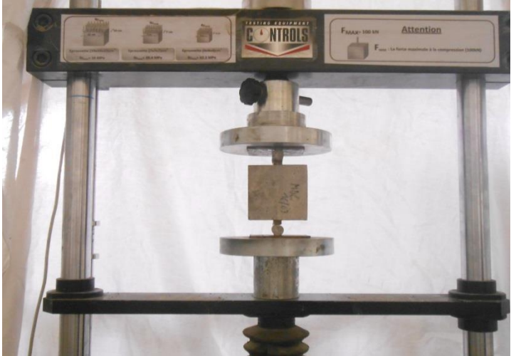
Figure III.20.Dispositif pour Essai WST selon la norme chinoise
