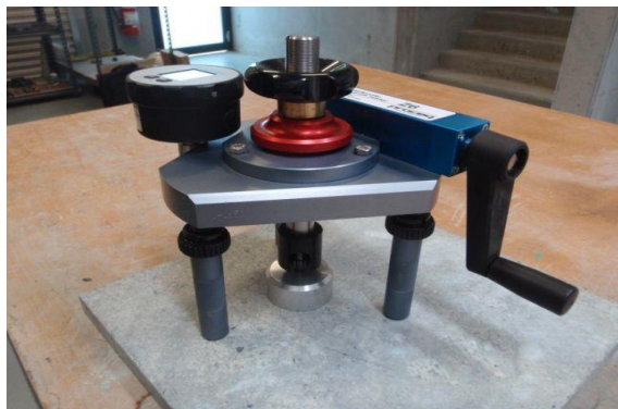
Figure III.15. Machine et méthodes l'essai pull-off
