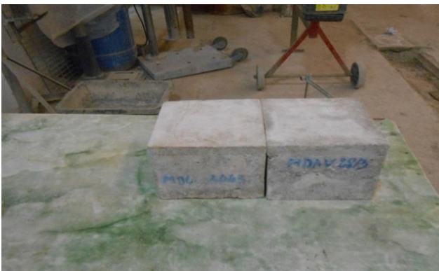
Figure V.10. Coulage des éprouvettes prismatiques 10 \times 15 \times 15 \text{cm}^3
