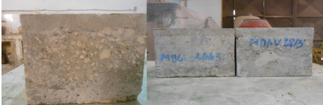
Figure V.18. Mortier réparation sur dalle 15X15X10cm
