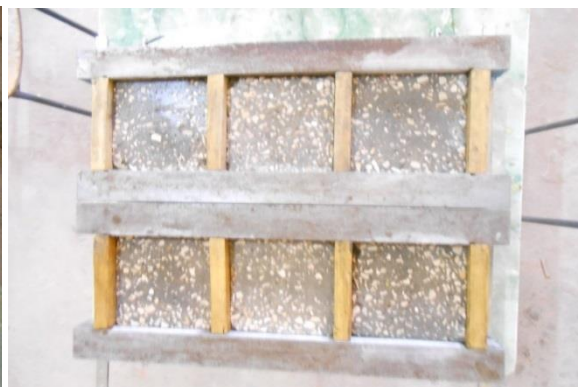
Figure V.10. Coulage des éprouvettes prismatiques 10 \times 15 \times 15 \text{cm}^3
