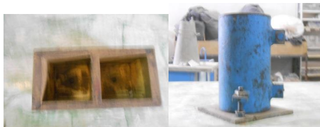
Figure IV.3. Les éprouvettes cubiques ( 10 \times 10 \times 10 \text{ cm}^3 ) et cylindriques ( 10 \times 20 \text{ cm}^3 )
