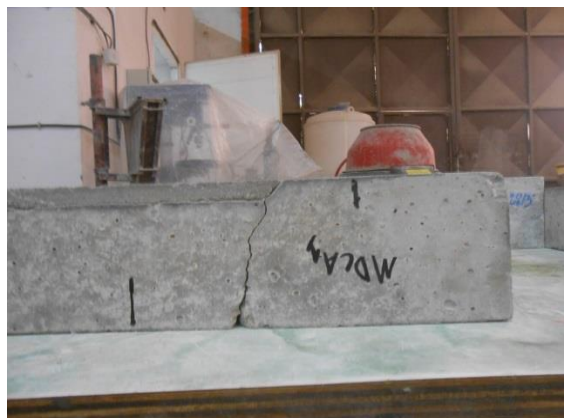
Figure V.17. Poutres 10X10X50 cm après écrasement
