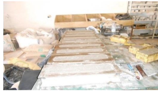
Figure V.4. Moule éprouvette de dimension 10×10×50cm
