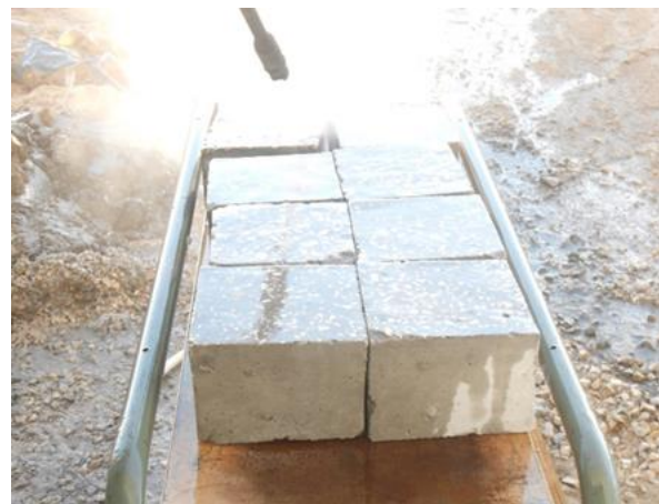
Figure V.6. Préparation de surface Eprouvettes prismatique 10×15×15.
