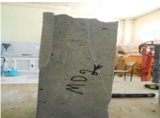
Figure V.17. Poutres 10X10X50 cm après écrasement
