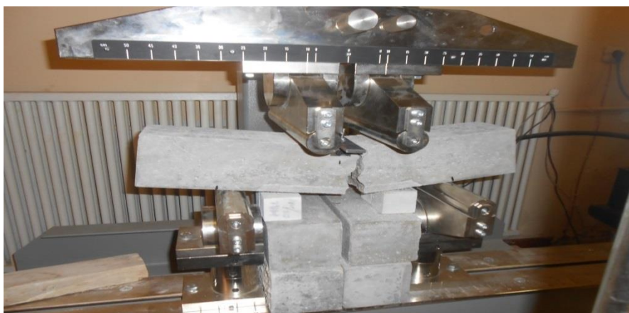
Figure III.17. Dispositif de flexion par quatre points pour les poutres 10×10×50cm.
