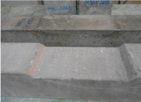
Figure V.9. Coulage des éprouvettes poutres de dimension 10 \times 10 \times 50 \text{cm}^3
