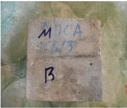
Figure V.7. Coulage des éprouvettes prismatiques en deux couches 5cm béton et 5cm mortier
