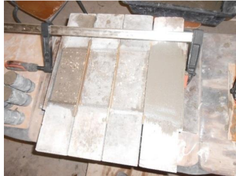
Figure V.9. Coulage des éprouvettes poutres de dimension 10 \times 10 \times 50 \text{cm}^3
