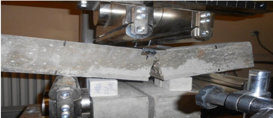
Figure V. 15. Essai Résistance à la flexion à 4 points
