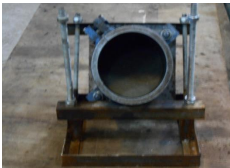
Figure.V.2. Moule d'éprouvettes cylindrique 10× 20cm
