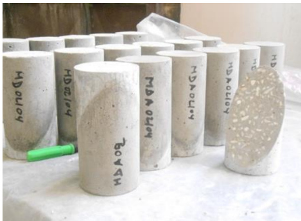
FigureV.8. Eprouvette cylindrique 10×20cm avant et après coulage de mortier
