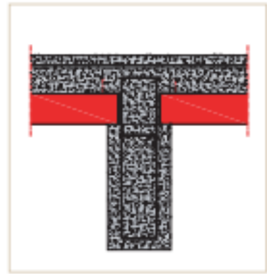
Pose en feuillure sur poutre béton
