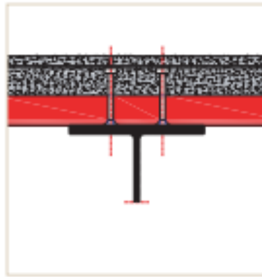
Pose filante sur poutrelle avec goudjons soudés
