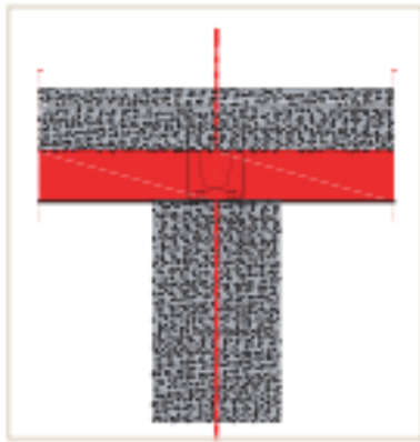
Pose filante sur poutre béton avec connecteurs pistonnés
