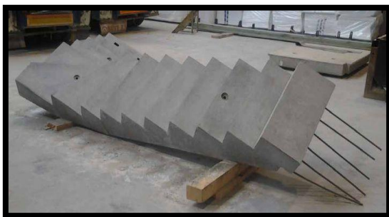
Fig37. V : escalier préfabriqué Source : http://www.bativox.be/fr
