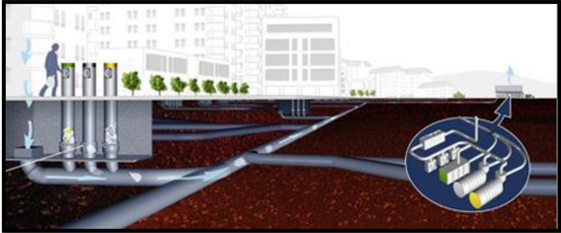
Figure 18 A Coupe sous terrain présent le réseau de transport Pneumatique des déchets
