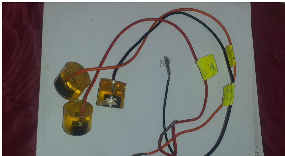
Figure IV.8 : les électrodes de travail.
