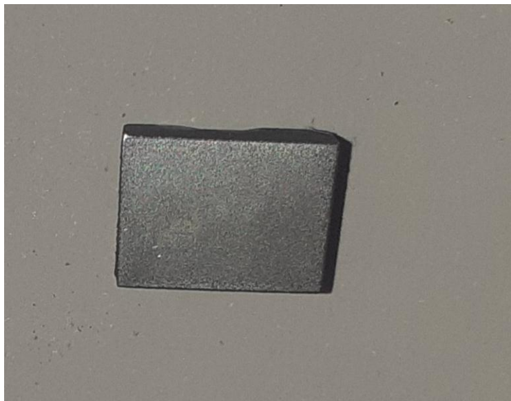
A : échantillon à l'état reçu, suivi d'un polissage de la surface
