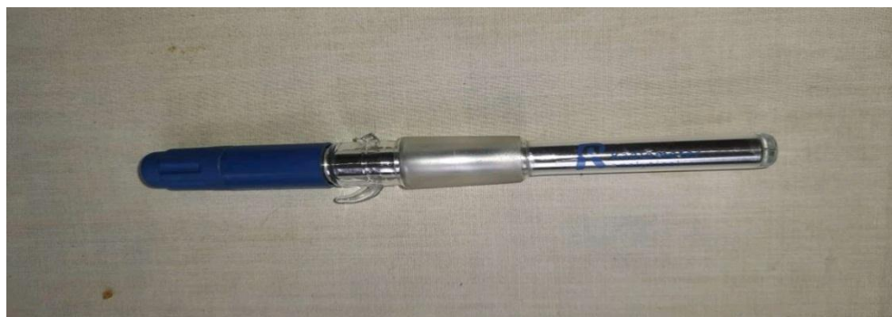
Figure IV.10 : les électrodes auxiliaire
