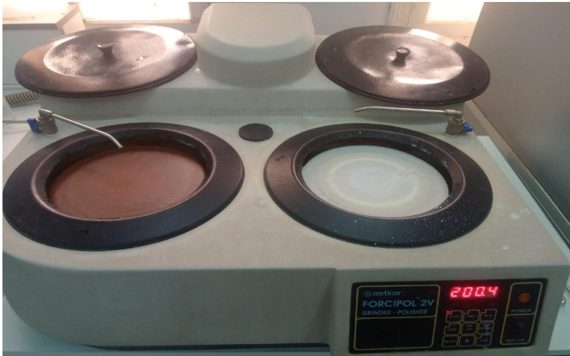
Figure IV.3 : la machine de polissage. (Labo LPM).
