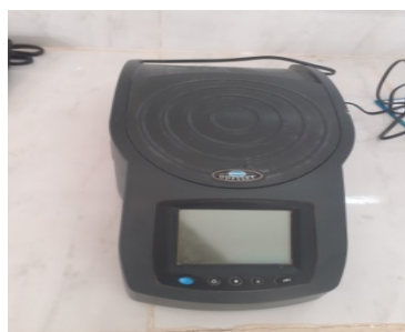
Photo.II.5: Spectrophotomètre et solution utilisée pour le phosphate
