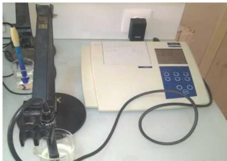
Figure III.03 : photo d'un conductimètre
