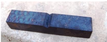
Figure III.3 Éprouvette avant rupture
