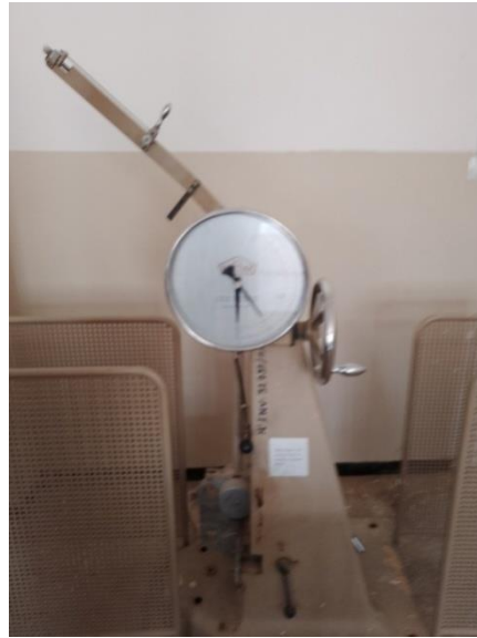
Figure II.7 Machine essai de résilience (Mouton pendule Charpy)
