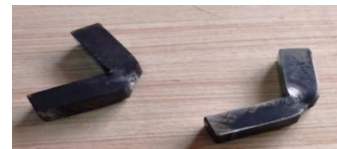
Figure III.4 Éprouvette après rupture
