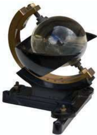
Figure(II-8): Héliographe de Campbell-Stokes [17].
