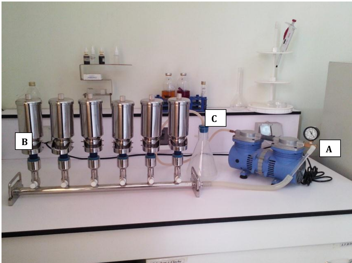
Figure 15 : appareil de filtration de membrane (A : pompe à vide, B recipient en inox de 600ml, C : Erlen de récupération de l'eau filtré)
