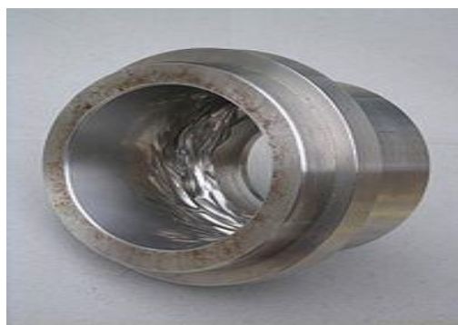
Figure I.2.8 : Schéma illustrant la corrosion frottement
