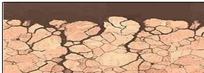
Figure I.2.5 : Schéma illustrant la corrosion sous contrainte.
