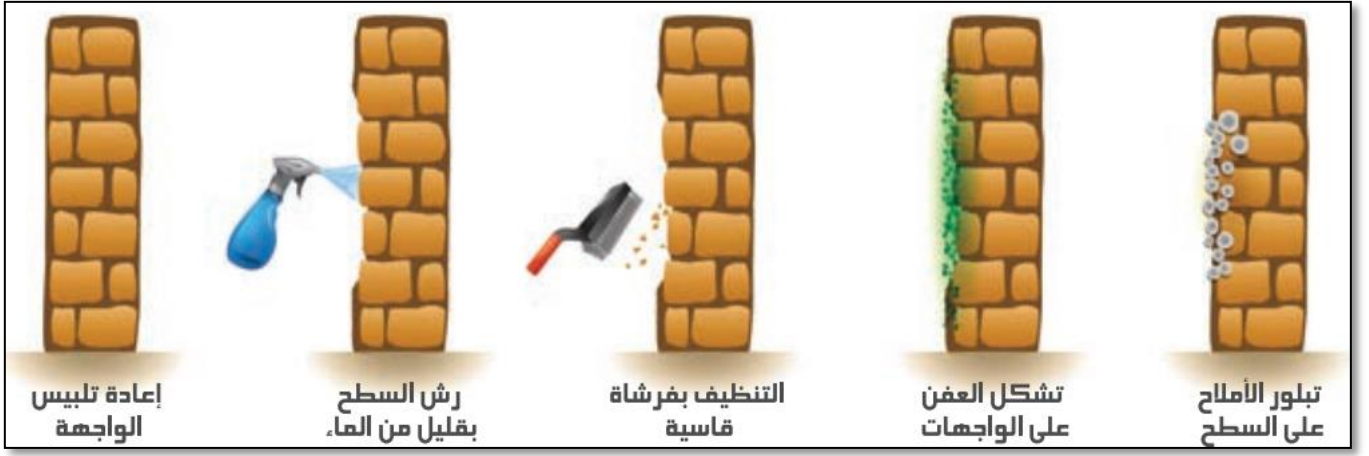
صورة 97 مراحل من عملية الترميم ومعالجة تبلور الأملاح (المصدر ترميم الواجهات)
