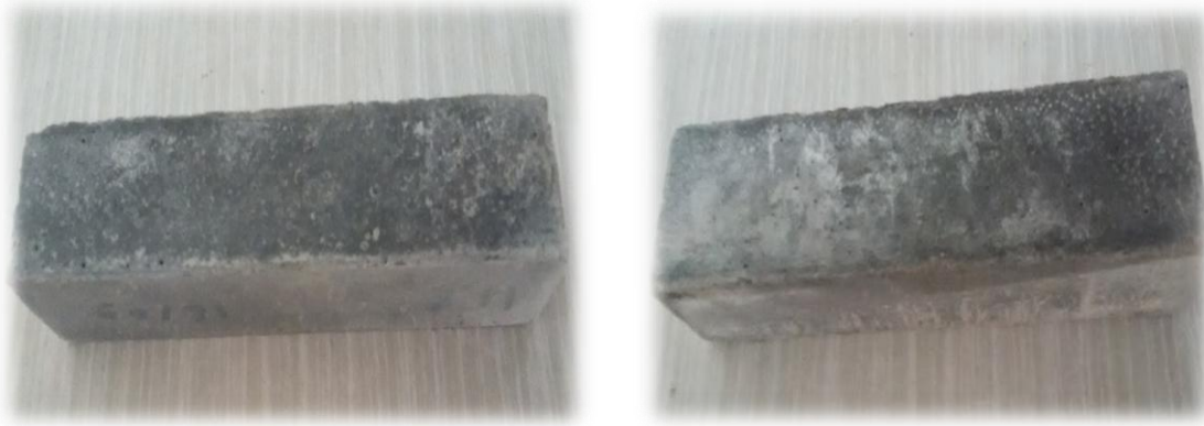
Figure 0-14 – Examen visuel des mortiers exposés à 5% \text{Na}_2\text{SO}_4 .
