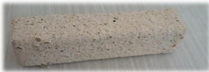
Figure 0-19 – Photos des éprouvettes après 336 jours d’immersion dans la solution de 2.5% de H 2 SO 4
