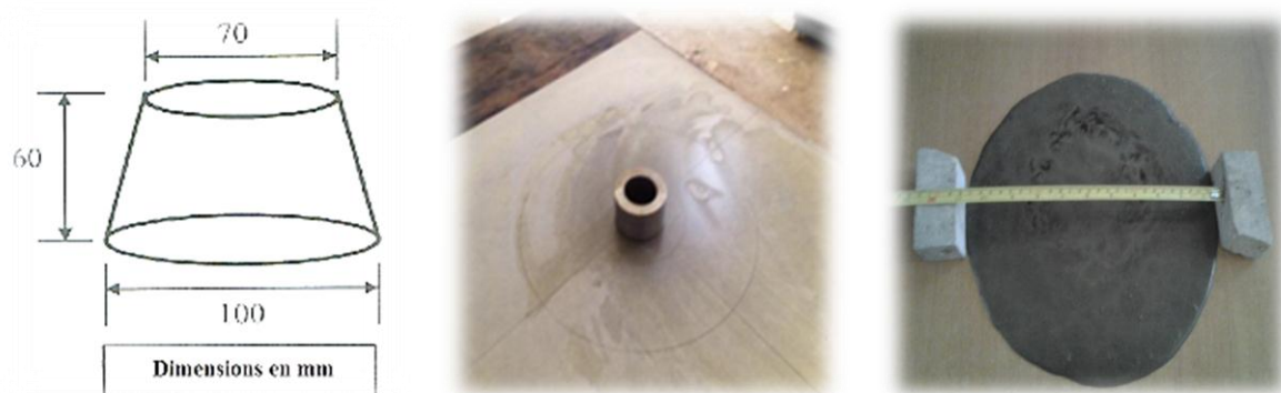
Figure 0-7 - Essai d'étalement pour mortier.
