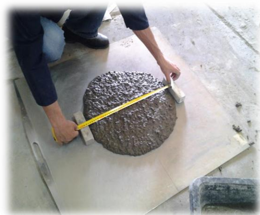
Figure 0-9 - Mesure du diamètre d'étalement.
