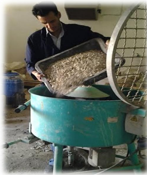
Figure 0-6 - Malaxage du béton autoplaçant.
