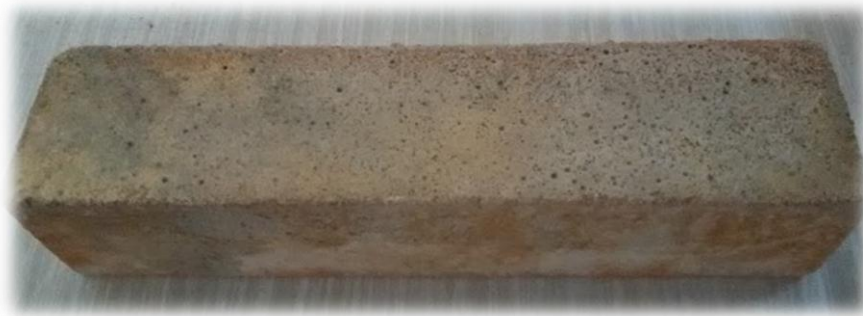
Figure 0-22 – Photos des éprouvettes après 336 jours d’immersion dans la solution de 1% de Hcl.
