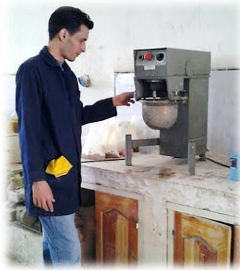
Figure 0-4 - Malaxage du mortier autoplaçant.
