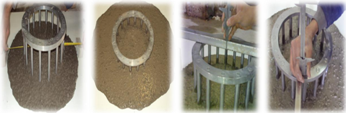
Figure 0-12 - Mesure d'étalement et des hauteurs à l'intérieur et à l'extérieur du J-Ring.
