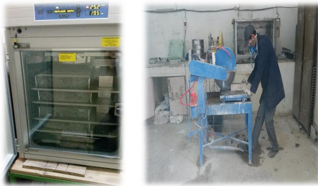
Figure 0-26 – Réalisation de l'essai Carbonatation accélérée.
