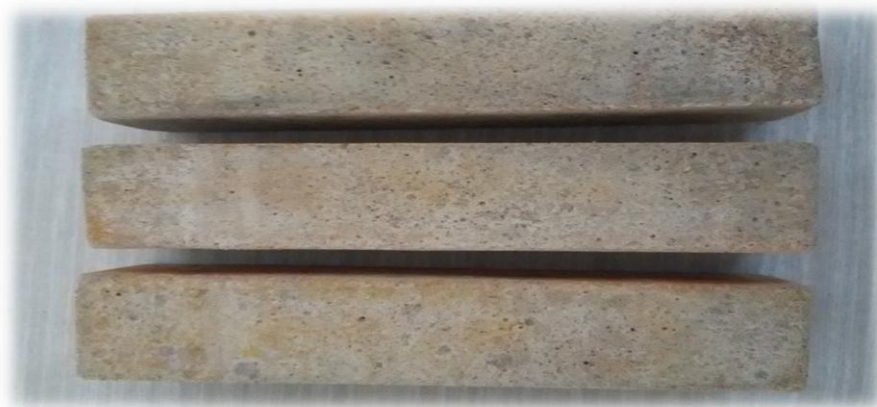
Figure 0-21 – Photos des éprouvettes après 336 jours d'immersion dans la solution de 1% de Hcl
