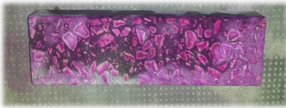
Figure 0-27 – Test à la phénolphthaléine et mesure du front de carbonatation (7x7x28 cm).
