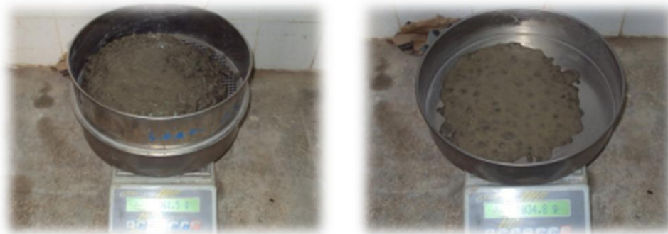
Figure 0-14 - Essai de stabilité au tamis.
