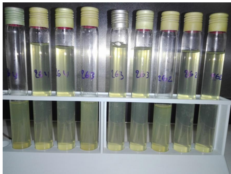
Figure 10 : Ensemencement des TSN par les échantillons de l'eau pour la recherche de clostridium sulfito-réducteur.
