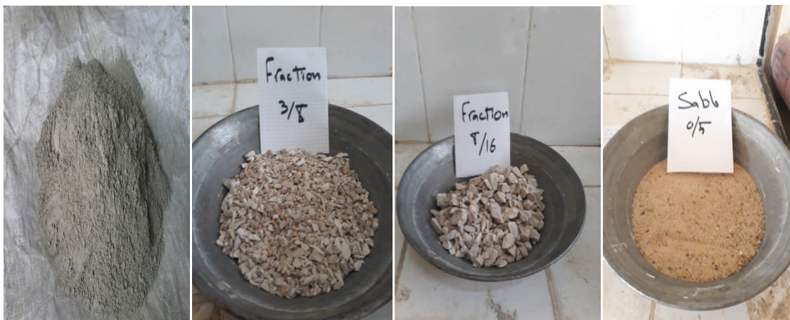
Figure I.1 les composants du béton.
