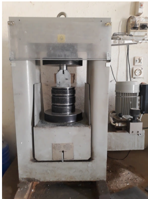
Figure II.17 : l'essai de compression a l'état durci
