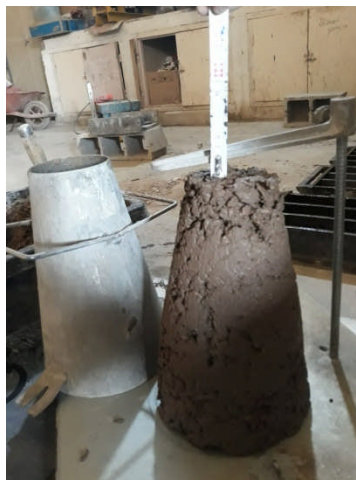
Figure II.16 : l'essai de mesure de consistance du béton frais.
