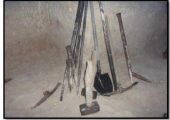
الصورة 13. بعض انواع الفاس و الشفرة المستعملة في البناء بالحي العتيق الاعشاش المصاعبة بالوادي
