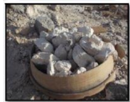
الصورة 14. الغربال المستعمل في البناء بالحي العتيق الاعشاش و المصاعبة بالوادي
