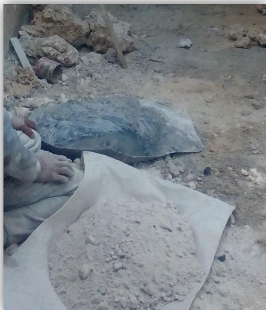
الصورة 11. القمطة المطاطية ( الشمبري ) المستعملة في عجن الجبس بالحي العتيق الاعشاش المصاعبة بالوادي
