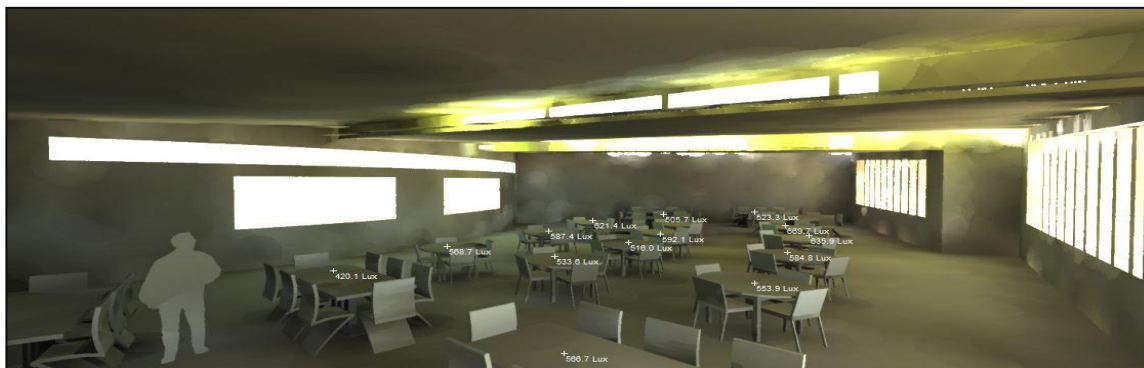
Figure .103 : Mesure de niveau d'éclairage à des points différents à ciel dégagé Source : Auteur
