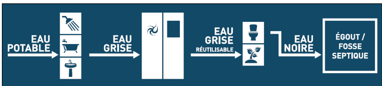
Fig. Schéma de recyclage d'eau grise
