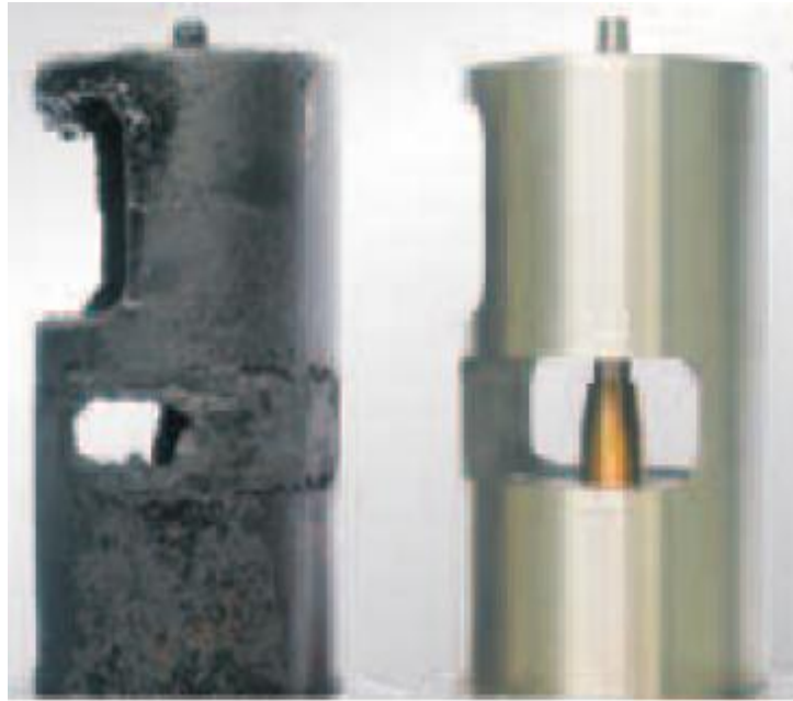
Figure III.3 : Encrassement d'une vanne EGR [78].
