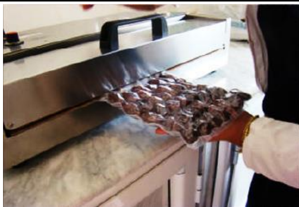
Figure 8: Procédé de mise en sachet sous vide (Dakhiaet al., 2016).
